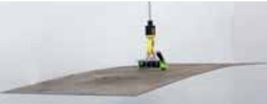
FX - P : 12 mm'den ince plakaları ve boruları kaldırmaya uygun (Lazer kesim sistemi için uygun)
