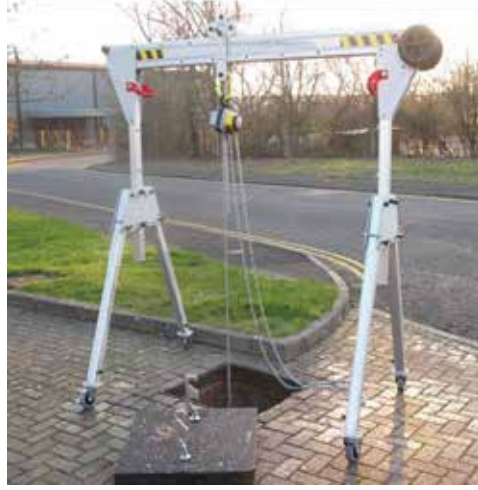
Kurtarma vinci opsiyonlu portal vinç, çalışma sahasından emniyetli mesafede kurtarma operasyonu sağlar.
